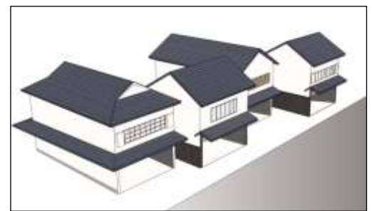
壁面線を揃える 軒高景観を整える
