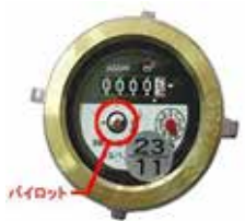
パイロット メーター表示板の例
